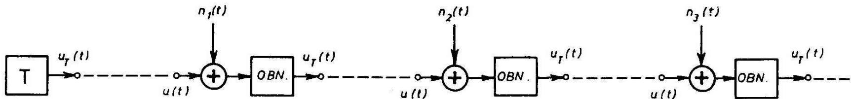
I ovdje pretpostavimo da se šalje polarni binarni signal  $u_T(t)$  čiji odbirci imaju amplitudu  $\pm U_T$ . Na kraju dionice signal će biti  $u(t)$ , a amplitude njegovih odbiraka  $\pm U$ . Samo, kako je riječ o regeneraciji signala, to je pobuda na ulazu prvog obnavljača:
